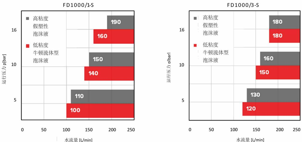
• 说明：高温型图中所示最小流量约增加25%，显示的数值仅适用于图4所示的泡沫液粘度范围。
